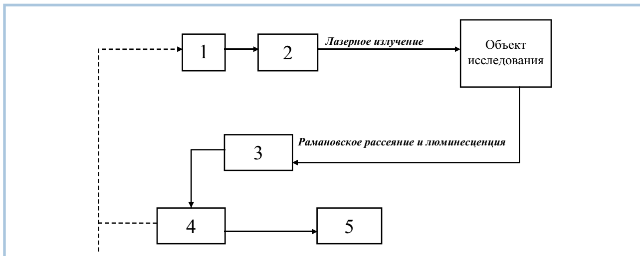
Рис. 3. Структурная блок-схема раман-люминесцентного АПК комплекса ИнСпектр.
